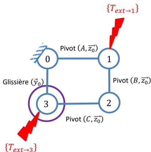
Actions sur la pièce 3 :  $\{T_{ext \rightarrow 3}\}; \{T_{2 \rightarrow 3}\}; \{T_{0 \rightarrow 3}\}$
