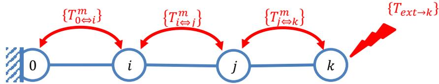
Connaissant l'action extérieure sur la pièce  $k$   $\{T_{ext \rightarrow k}\}$ , on souhaite par exemple déterminer l'action dans la liaison  $L_{0i}$ .
